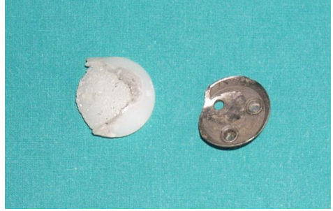
Şekil-1. Diz eklem protezinin metalik patellar komponentinde meydana gelen aşınma.
