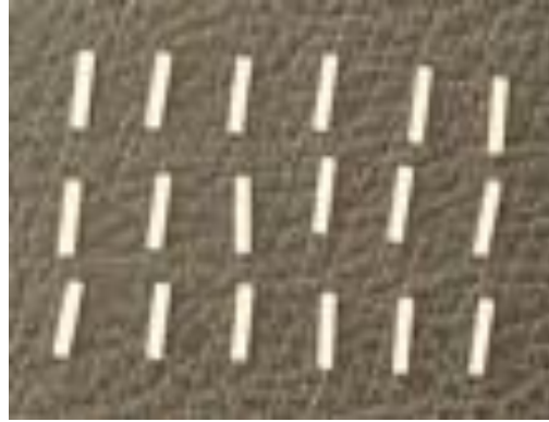
Şekil-3. 1 mm çapında 6 mm uzunluğunda TLD-100 çubukları.
